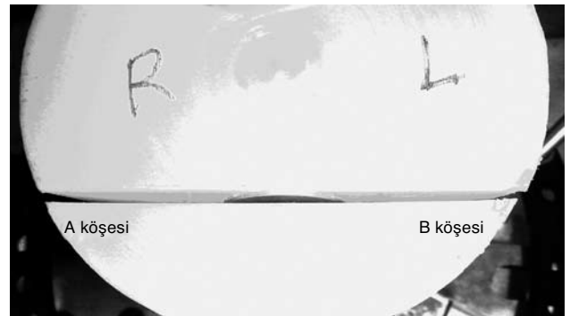
Şekil 4. Diverjan tel germe yöntemi. Teller 80 kg ile gerildikten sonra kırık hattı simetrik.
