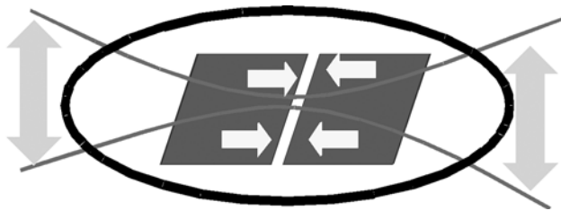
Şekil 1. Diverjan tel germe yöntemi. Proksimal teller halka üzerine diverjan eğimle açılarak gerilir (artiküler yüzey).
